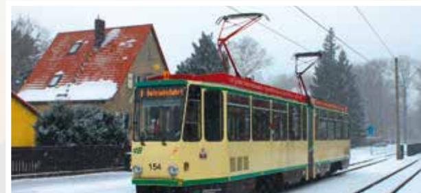
Auf dem Triebwagen 154 wurde eine Fahrdrähtenteilungsanlage montiert, welche bei kalten, verschneiten und vereisten Wintertagen eingesetzt wird. Um die Oberleitungen für den Linienverkehr in Fahrbereitschaft zu halten, wird in den Nächten unsere Oberleitung mit einem speziellen Frostschutzmittel bestrichen.
