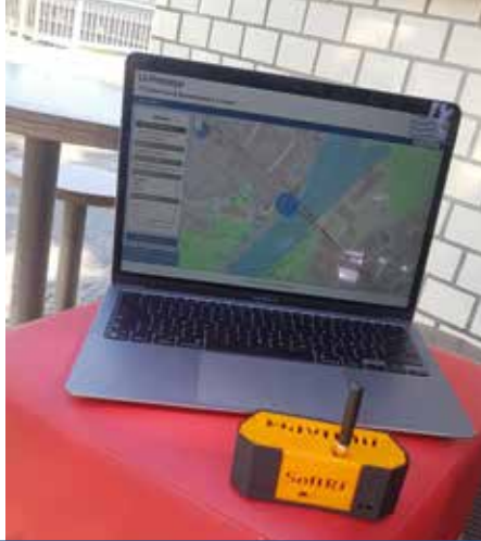
Laptop mit Visualisierung und erster LoRaWAN-Sensor, der Personen in der Umgebung anhand ihrer Bluetooth-Signale zählt
