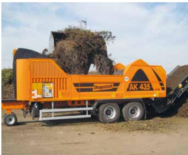
**Unser mobiler Zerkleinerer:** Er zerkleinert zum Beispiel Grün-, Ast-, Baum- und Heckenschnitt, Altholz, Wurzeln, Stammholz sowie biogene Brenn- und Gärstoffe.
