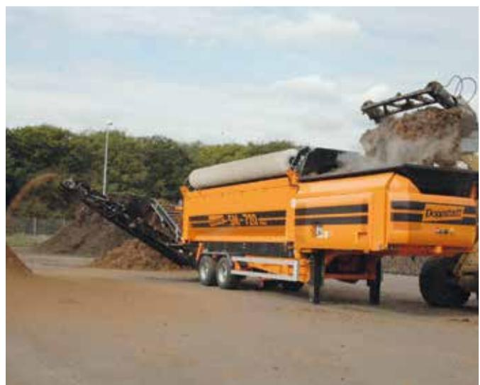
**Unsere mobile Siebmaschine:** Sie zerkleinert zum Beispiel Kompost, Bodenaushub, Sand/Kies, Bauschutt, Altholz und natürlich auch biogene Brenn- und Gärstoffe.
