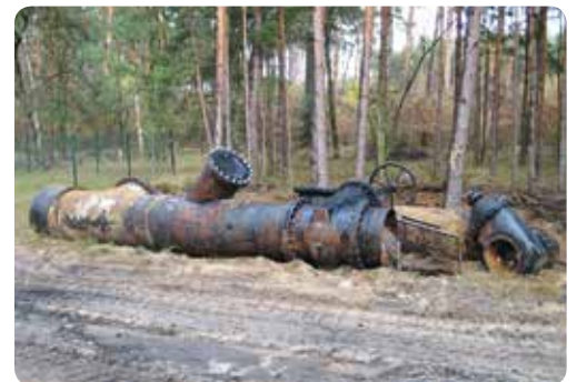
Armaturen aus dem alten Schieberschacht
